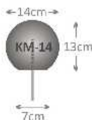
Kula betonowa KM-14 z prętem zbrojeniowym o średnicy 6 mm
