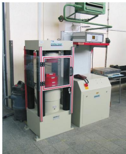
Badanie wytrzymałości próbek betonu
