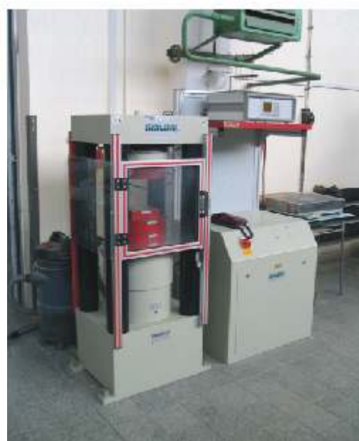
Badanie wytrzymałości próbek betonu
